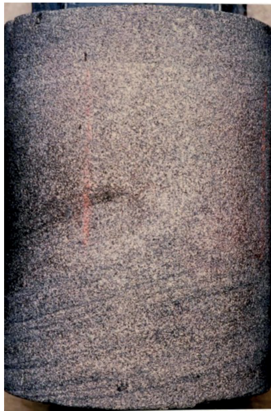
Figura 6. Núcleo 10-12-57-19W5 (Formación Bluesky, Alberta, Canadá). Profundidad: 2664 metros. Sutil contacto irregular entre una arenisca con estratificación cruzada muy difusa (mitad inferior) y una arenisca similar, pero totalmente bioturbada por meiofauna y sin estructuras visibles (mitad superior). Diámetro del núcleo: 4 pulgadas. Fuente: [12]
