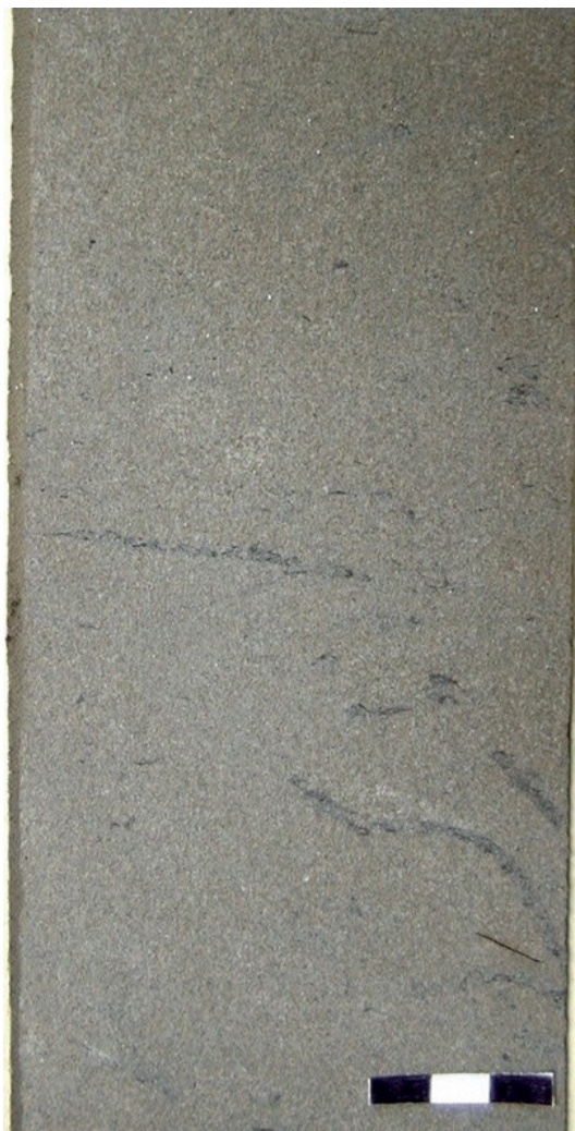
Figura 3. Núcleo LL-3577 (Formación Misoa, B-2, Lago de Maracaibo, Venezuela). Profundidad: 3882,8 pies. Arenisca de grano fino totalmente bioturbada por meiofauna, aunque es posible observar todavía algunas trazas de Ophiomorpha . Escala en cm. Fuente: [14].
