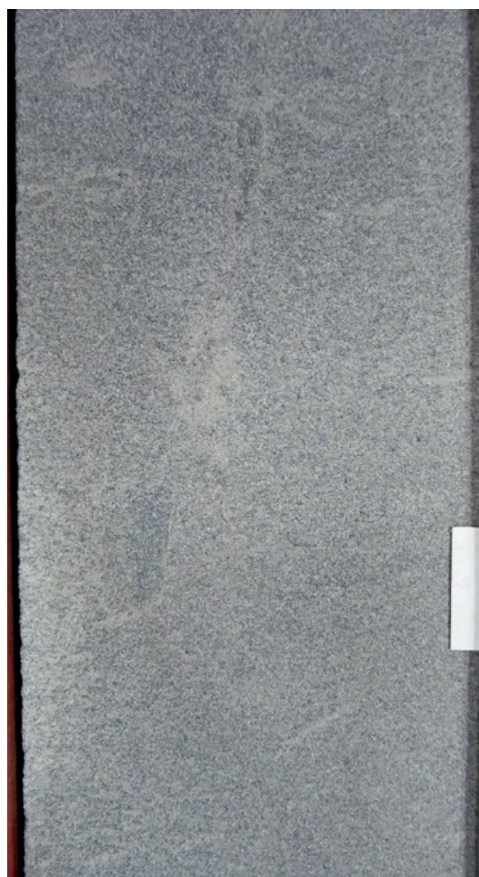
Figura 8. Núcleo JM-190 (Formación San Juan, Cuenca Oriental de Venezuela). Profundidad: 9479,4 pies. Arenisca de grano fino totalmente bioturbada por actividad meiofaunal, aunque es posible observar todavía, pero sumamente difusas, huellas de Ophiomorpha y Macaronichnus juveniles. Escala=1 pulgada. Fuente [34].
