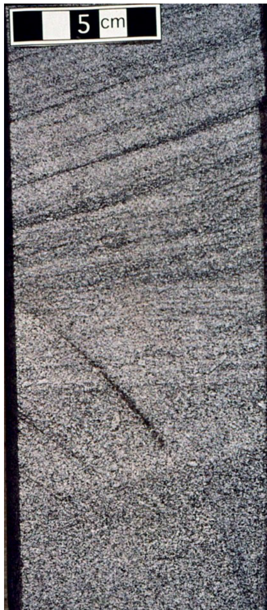
Figura 5. Núcleo 7-25-71-13W6 (Miembro Falher, Formación Spirit River, Alberta, Canadá). Profundidad: 1998,6 metros. Arenisca de grano fino a medio, moderada a fuertemente bioturbada por meiofauna. Es posible observar que la laminación cruzada va tornándose difusa, casi desapareciendo hacia la base del núcleo, a medida que aumenta la intensidad de la bioturbación meiofaunal. Es posible reconocer en esa zona basal, algunos pequeños Macaronichnus sp. Fuente: [14].
