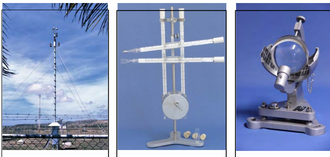
Figura 4. Desde la izquierda: anemógrafo universal (Aeropuerto de Porlamar; Isla de Margarita (Fotografía: SFP, 1992). Psicrómetro de August. Heliógrafo Campbell-Stokes (Fuente: Müller, 2017).
