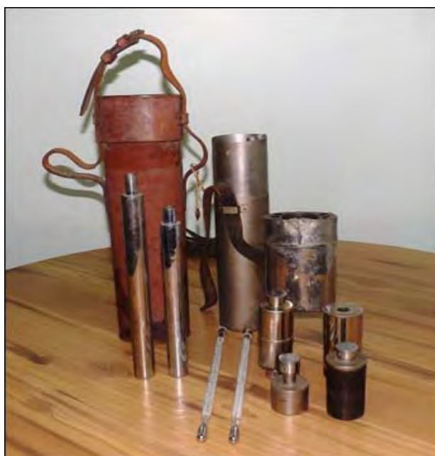
Figura 7. Hipsómetro. Sus componentes incluyen dos termómetros, cuyas escalas se adaptan a diferentes altitudes; soportes tubulares (camisas) para los termómetros; contenedores para el alcohol y el agua destilada; cocinilla; cilindro protector metálico y estuche de cuero. (Instrumento donado en 1971 por A. W. Goldbrunner al Departamento de Geografía e Historia del Instituto Pedagógico de Caracas. Fotografía: Franklin Núñez Ravelo, mayo 2107)
